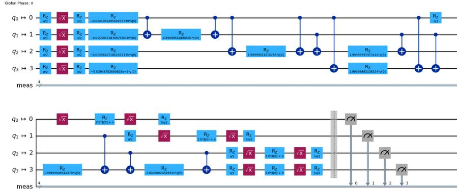
Figure 8: Circuito a 4 qubit parametrizzato per il QAOA con rumore.
